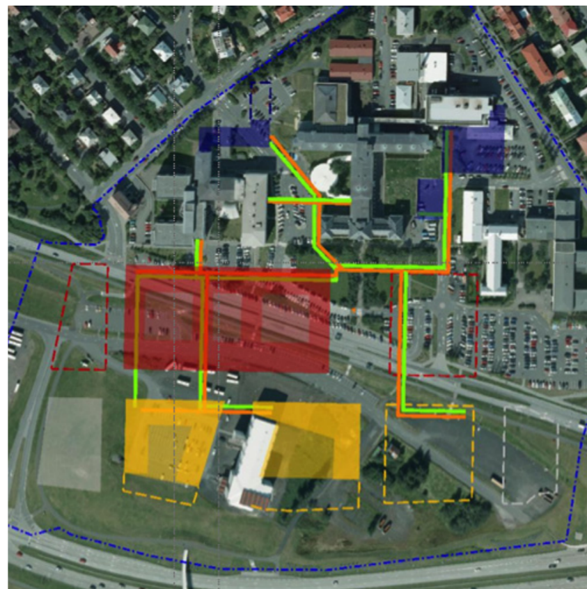
Skýringamynd sem sýnir leiðir rörpósts og AGV.
